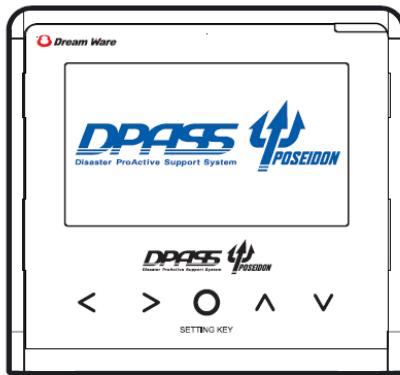
本製品は緊急地震速報を受信し、各地での震度、到達時間を瞬時に予測演算し報知を行うものです。
