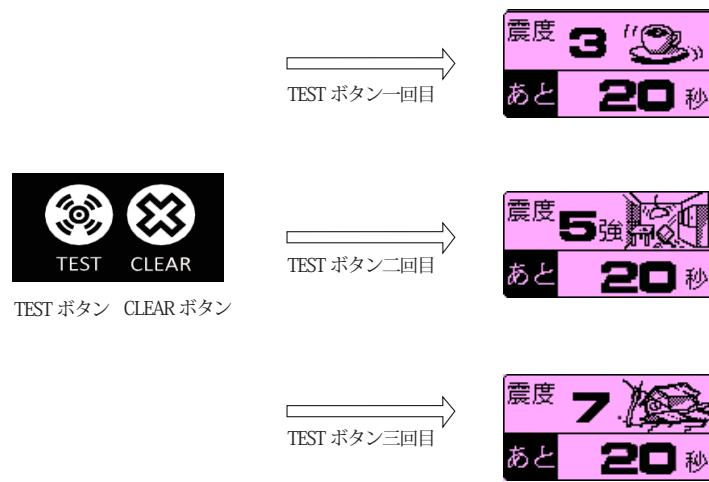
本体のTESTボタンを約3秒長押すことより、地震速報のテストの報知が実行できます。一回目は震度3、二回目は震度5強、三回目は震度7、4回目は震度3にもどり報知します。
