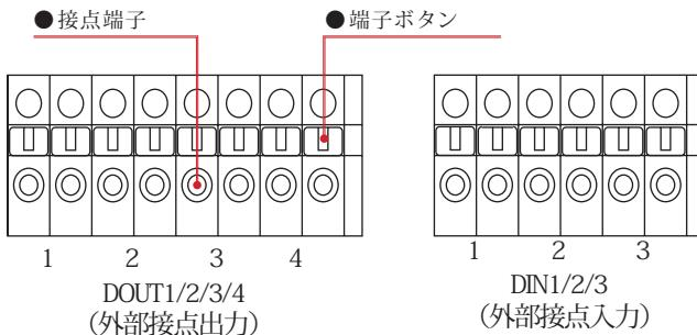
※無電圧ループ接点になっています。定格電圧(38V)を超える電圧は与えないでください。故障の原因となります。
